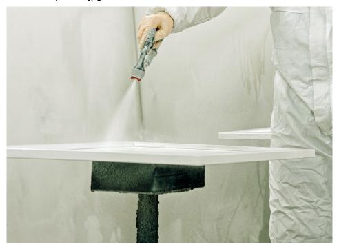
Der PUR CL-241-Colorlack 4in1 besticht durch sein gutes Stell- und Deckvermögen bei der Kantenbeschichtung und komplexen Teile-Geometrien.
